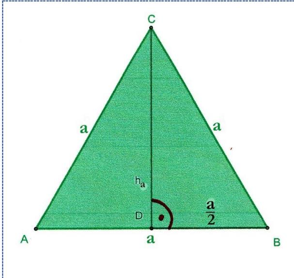
Aus dem rechtwinkligen Dreieck BCD oder ACD kann die **Höhe  $h_a$**  berechnet werden:
